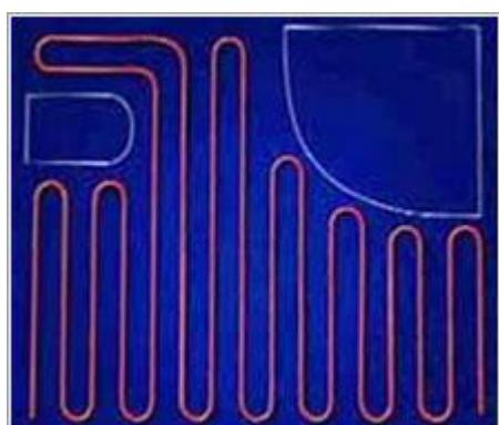
На плане отдельного помещения или всей квартиры необходимо разметить схему укладки и место подключения нагревательного кабеля, а также определить расположение термостата и датчика.
