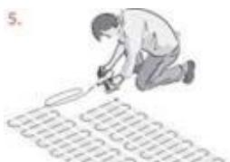
Измерьте сопротивление изоляции и жилы до нанесения плиточного клея или цементно-песчаного раствора.
