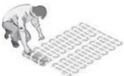
На выровненной поверхности раскатайте сетку, и, надавив на неё, приклейте. Резать кабель нельзя, только сетку! При укладке важно, чтобы муфта находилась в полу, а холодный конец кабеля заходил в терmostат.
