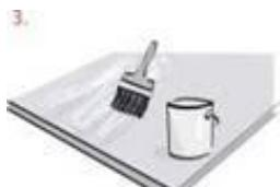
Для удобной фиксации сетки на поверхности, стяжку необходимо обработать грунтовкой. Сетка должна устанавливаться на прочной и ровной основе, минимальной толщиной 5мм
